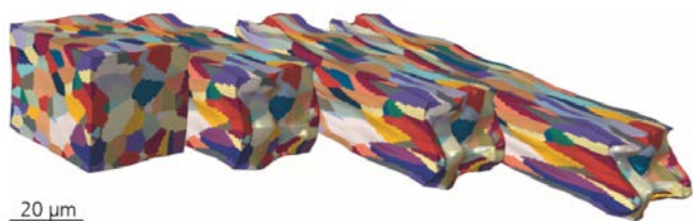
4: Diese Prozesskettensimulation beschreibt die Veränderung von Werkstoffeigenschaften im Fertigungsprozess: und zwar die Entwicklung der Mikrostruktur von Kupfer während des Drahtziehens. (Bild: Fraunhofer IWM)
